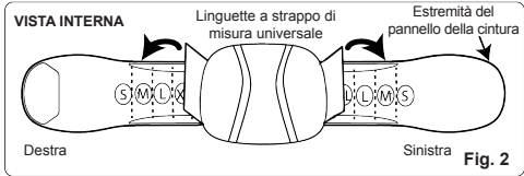
Fig. 2: Regolare le dimensioni facendo passare i pannelli attraverso l'anello a D fino alla taglia desiderata. Le taglie sono chiaramente contrassegnate all'interno di ogni pannello. Allineare le estremità del pannello agli indicatori della taglia desiderata, quindi fissare saldamente ogni pannello al velcro.
